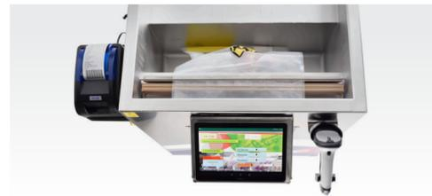
Las bolsas están hechas con materiales altamente resistentes, lo que permite la conservación de las muestras hasta 72 horas. La técnica de conservación al ultravacío retrasa el proceso de autólisis (a causa de la ausencia de aire dentro de la bolsa).
